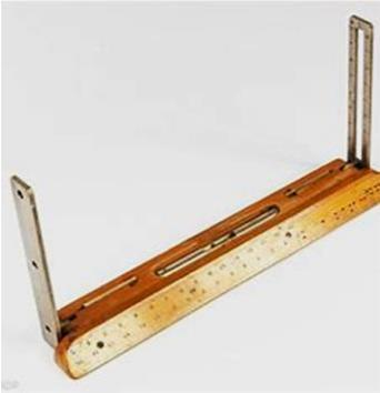
Le second est une **alidade nivélatrice**. C'est une sorte de règle de bois de 20 ou 25 cm de longueur, biseautée, aux extrémités de laquelle sont fixées, d'une part, une pinnule à trois œillets, d'autre part, une pinnule-fenêtre graduée. Au milieu de la règle est enchâssée une nivelle, et deux excentriques de calage sont disposés près des extrémités.
